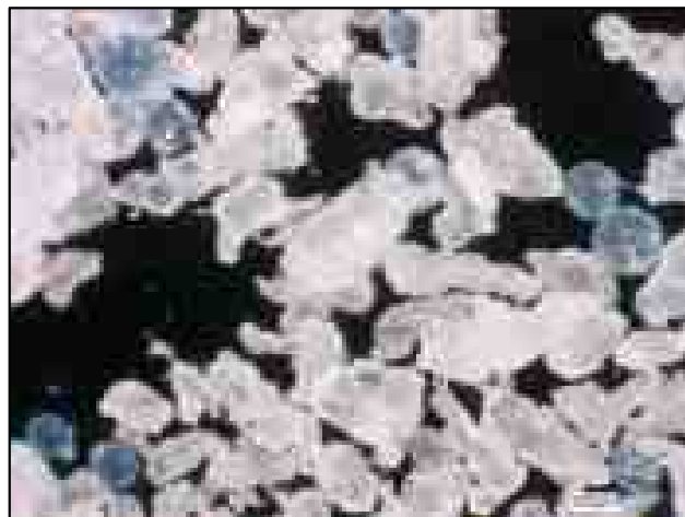
粒径:平均 287 \mu\text{m} (最小 76 \mu\text{m} , 最大 416 \mu\text{m} )
