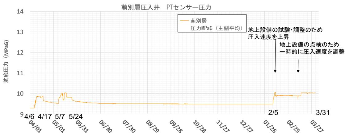
図-5 萌別層圧入井の坑内圧力 (坑底) の推移
