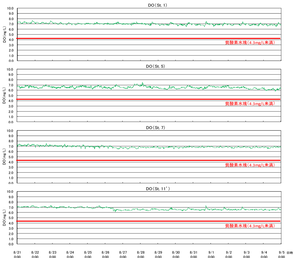
図 3.3-2 三津湾の底層（海底上 0.5m）における連続観測（DO）の結果（8月）
