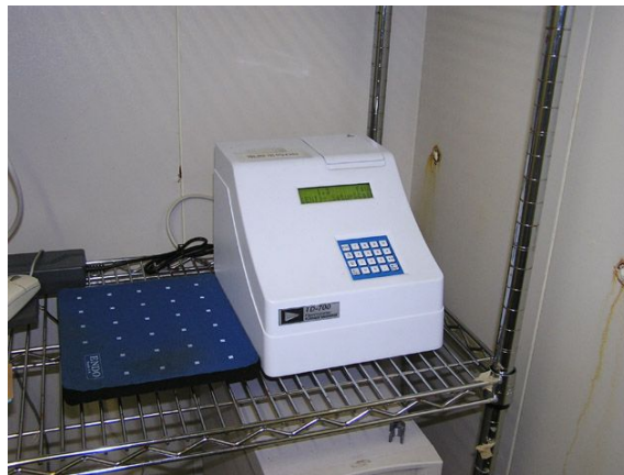
図 4.3 蛍光光度計（ターナーデザイン社 モデル TD-700）
