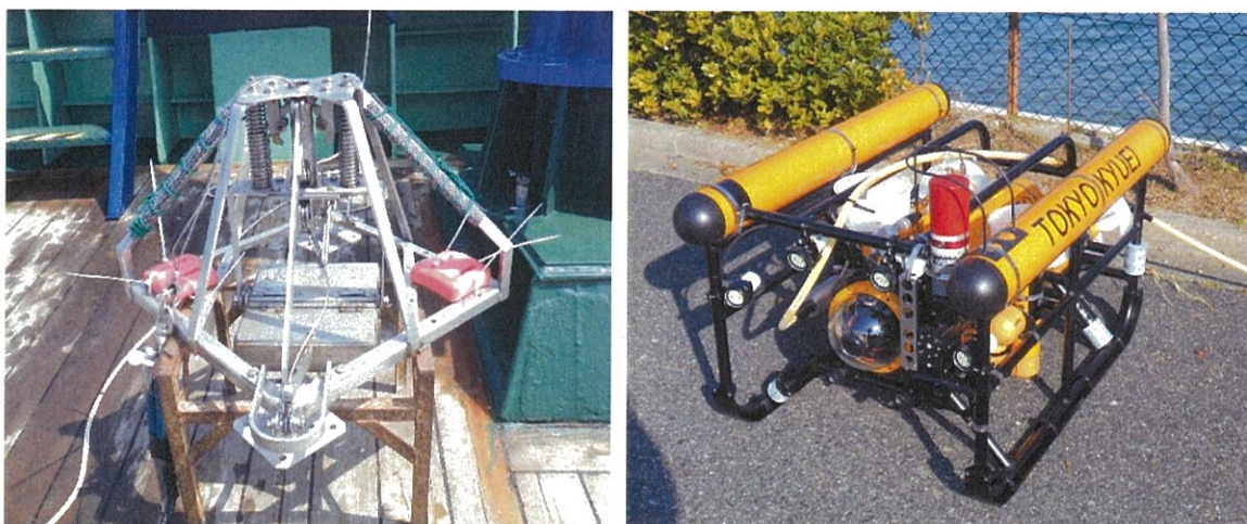
第 1 図 スミス・マッキンタイヤ型採泥器（左）および ROV（右）
