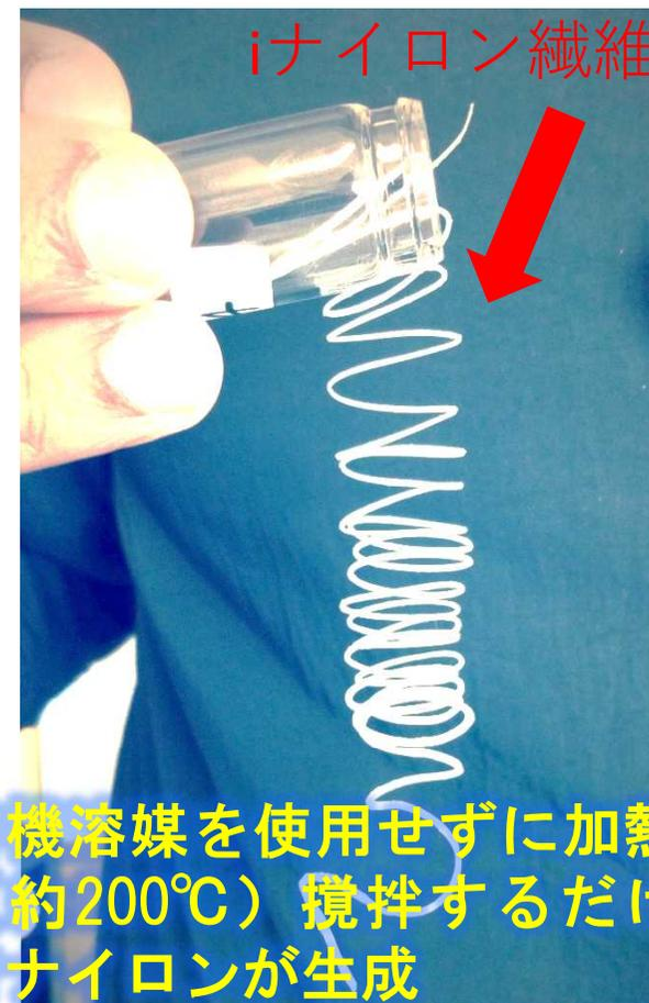
有機溶媒を使用せずに加熱（約200℃）攪拌するだけでナイロンが生成
