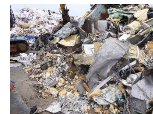
断熱材(フロン含有)が散乱した業務用冷凍冷蔵機器
