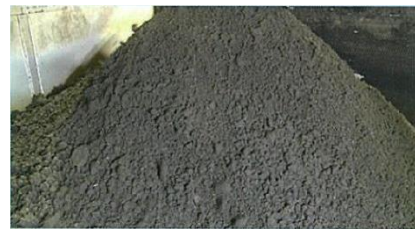
脱水汚泥（助燃剤）
