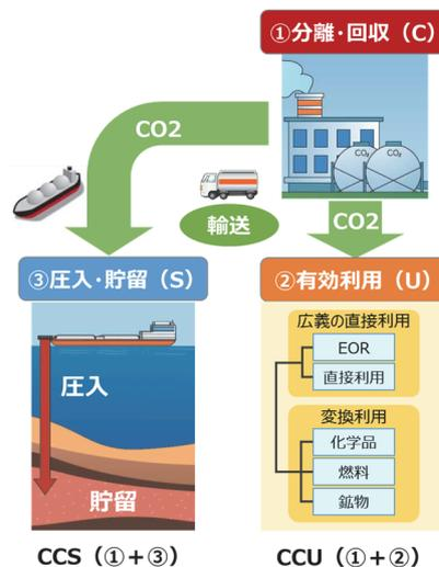
図 11-46 CCUS の概要
