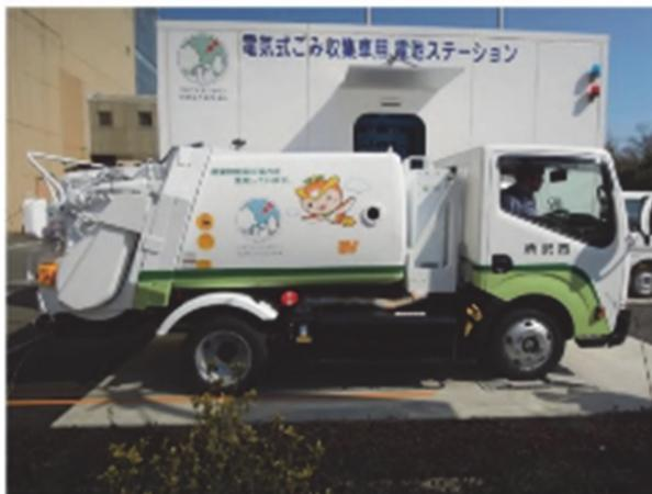
図 II-58 バッテリー交換型 EV パッカー車と給電・蓄電システム（電池ステーション）
