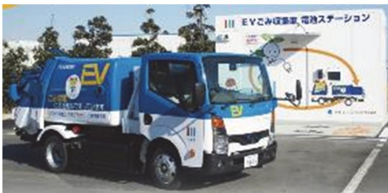
図 II-59 EV ごみ収集車（電池交換型）と電池ステーション
