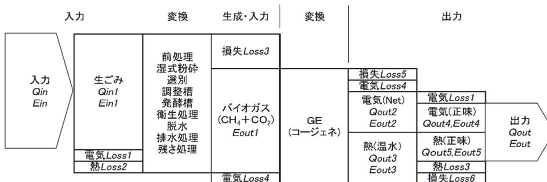
図 II-30 メタン化システムのエネルギー収支フロー図
