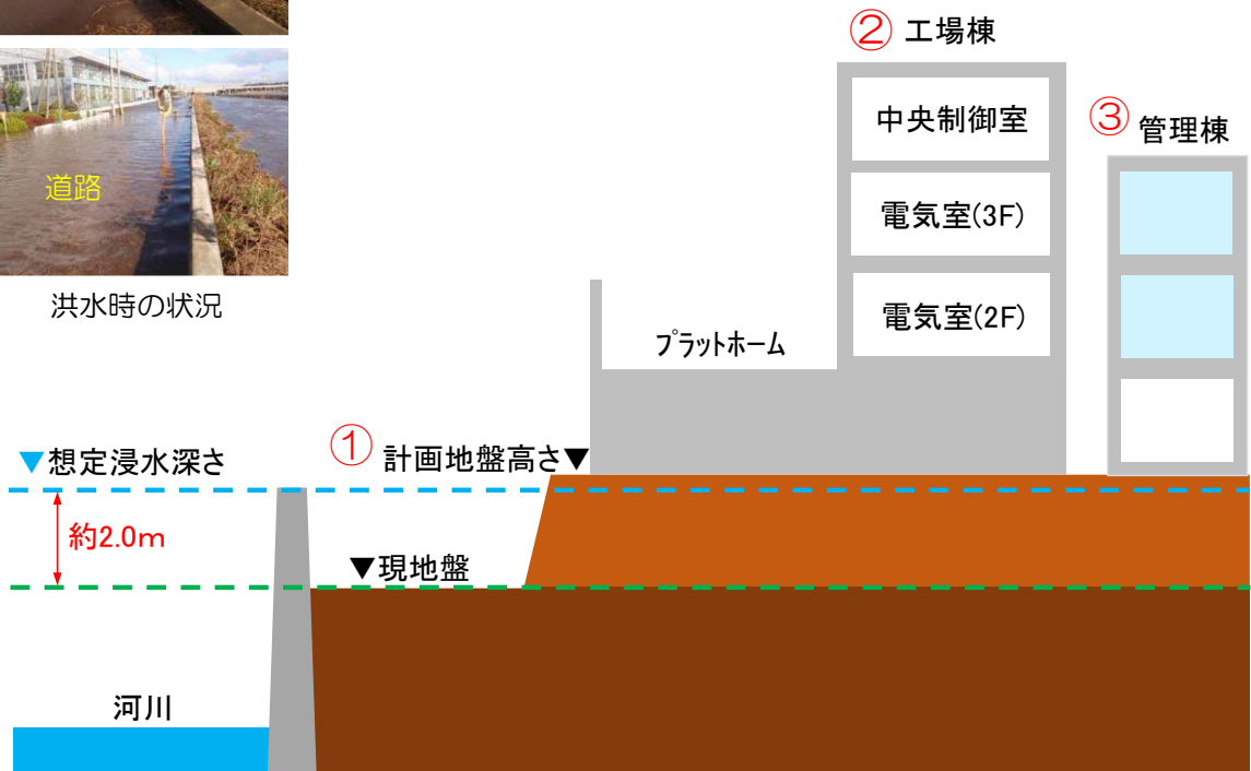
用地の盛土、部屋や設備の鉛直方向による対策事例
