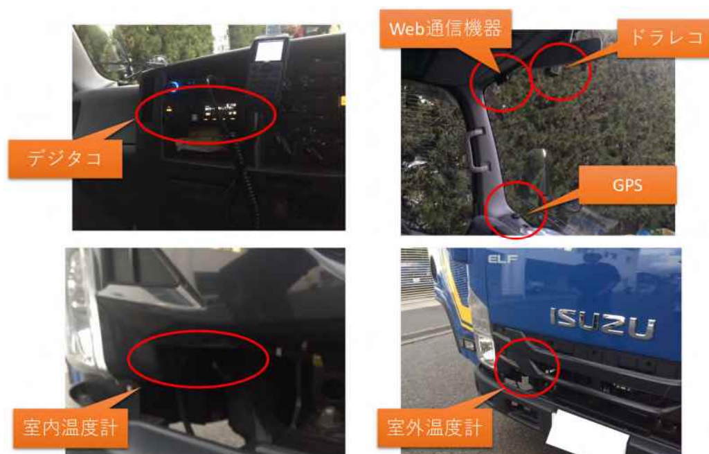
図 7.1-2 デジタルタコグラフの設置状況
