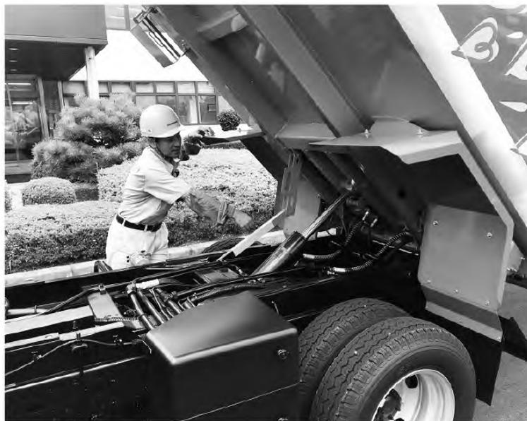
図 6.5-3 架装部の巻き込まれ防止センサー
