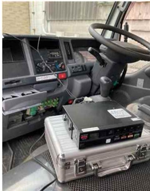
図 3.2(1)-2 実走行調査で設置したデジタルタコグラフ
