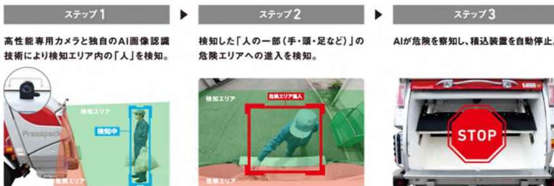
図 6.5-1 画像判定を利用したごみ収集車安全支援システムの例(その1)
