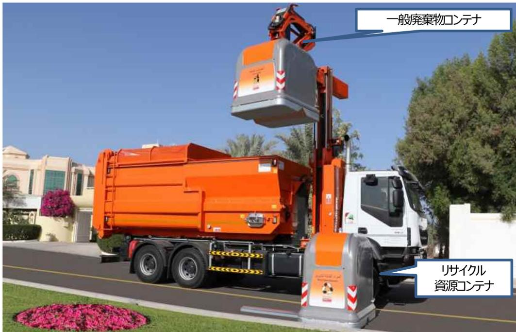
ドバイ・Al Mamzar 地区で導入されている非接触のごみ収集システム。収集車はコンテナを掴み上げ、内容物を荷台に移した後、少量の水でコンテナを洗浄し、元の場所に戻す。
