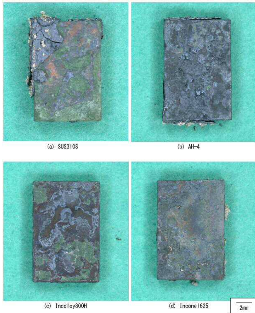
図 3-4-5 各時効材の 800°Cにおける 1,000 h 腐食試験後の試験片の外観
