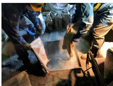
図 1.4.1-1 AP での燃焼灰の手投入の様子
