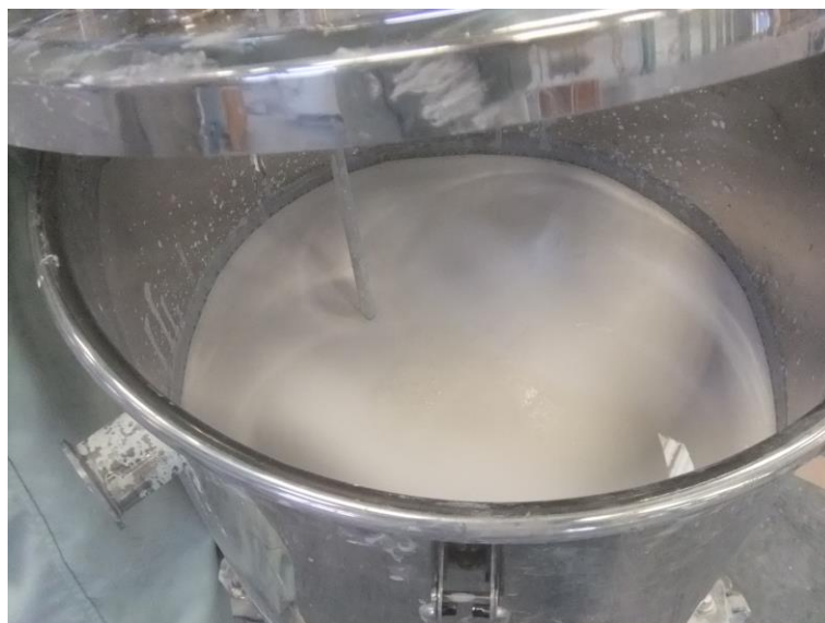
図 2-12 触媒スラリーを混合した状況
