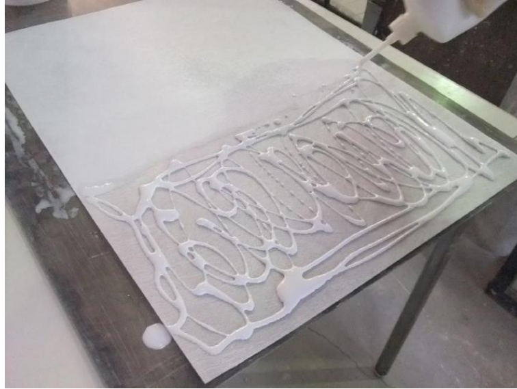
図 2-13 触媒スラリーをガラス繊維ペーパーに塗布した状況
