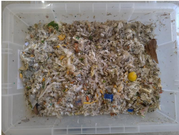
写真 2-2-4-9 E: 分別機の通過物 (発酵対象物)
