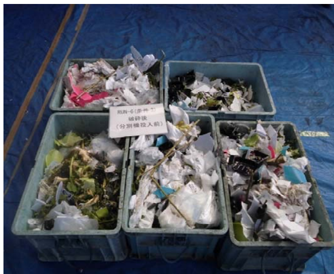
写真 3.2.2.4-1 二軸破碎後の模擬ごみの様子
