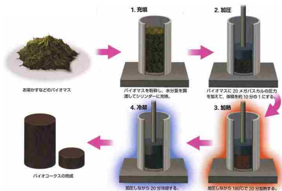
図表 1-3 BIC 製造工程
