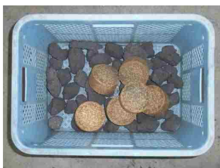
図表 2-2.40 石炭コークス+J-Coal 製造 BIC-3 (5kg)
