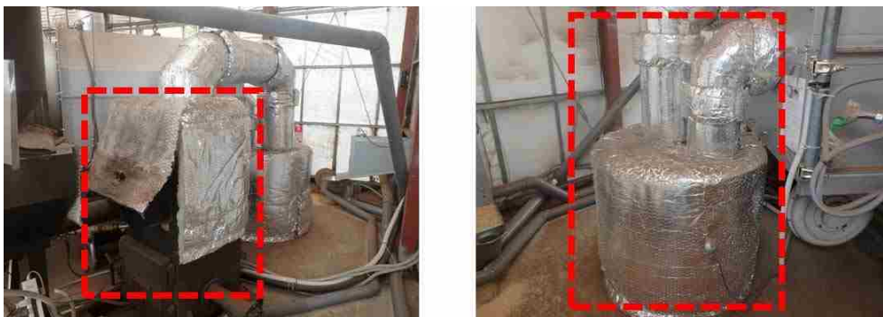
図表 2-3.15 籾殻燃焼器 (左：燃焼部、右：熱風供給部)
