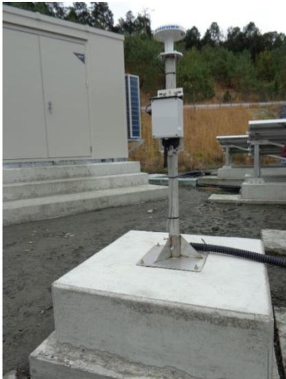
写真7.1-42 沈下測量GPS (G-1)
