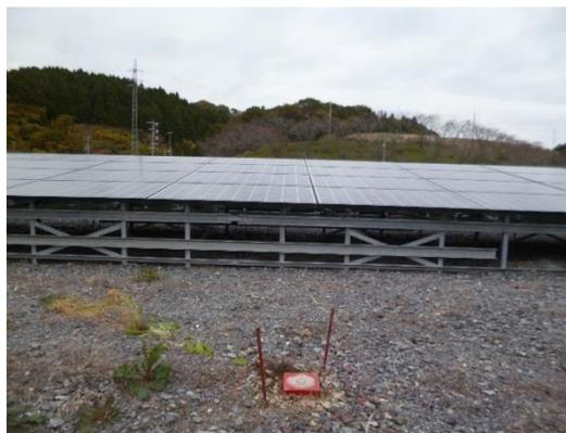
写真7.1-26 不等沈下観測のための計測点
