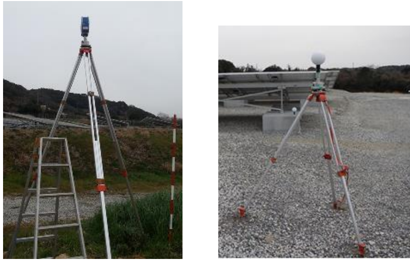
図 3.4-12 地上型レーザーによる計測状況（左：地上型レーザー、右：基準球）
