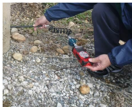
図 3.4-24 ガス検知器による現地計測
