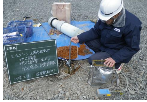
図 3.4-30 減圧捕集法によるガス採取
