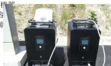
図 移動可能型リチウムイオン蓄電池
