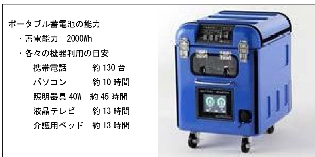
図5-1 ポータブル蓄電池の外観並びに能力
