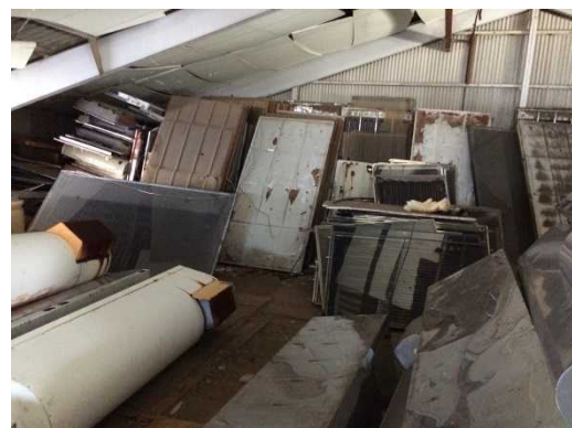
取り外した機器の集熱部ガラスとタンク (施工業者が保管しているもの)
