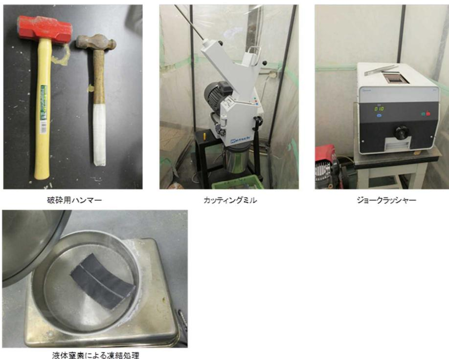
図 1-50 破砕に用いた装置・器具等
