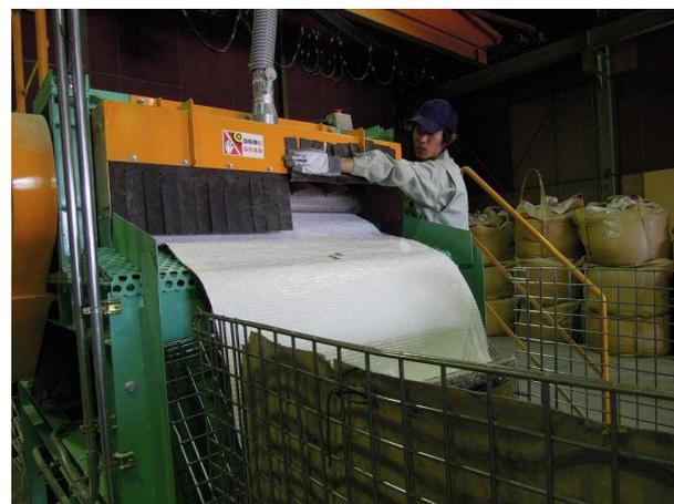
図 1-24 破砕機での破砕の様子
