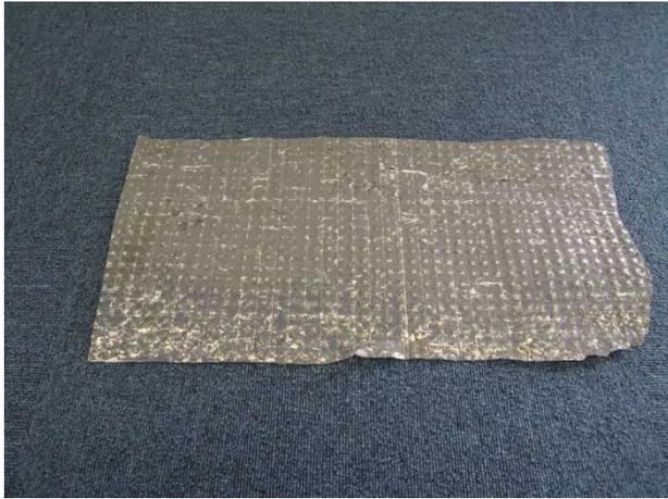
図 1-27 破砕機投入後のモジュール
