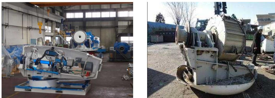
図 3-23 100kW 風車のナセル内構造の比較
