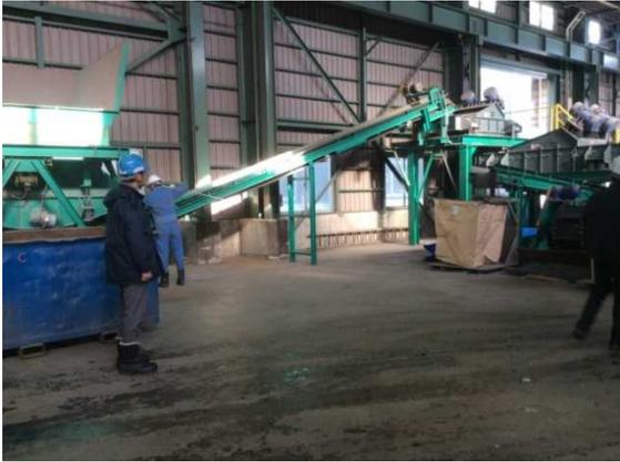
図 1-33 破碎後ホッパーへ投入
