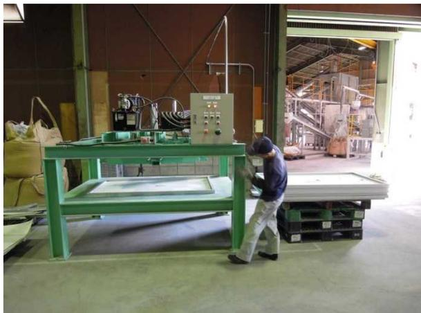
図 1-22 アルミフレーム枠外し機
