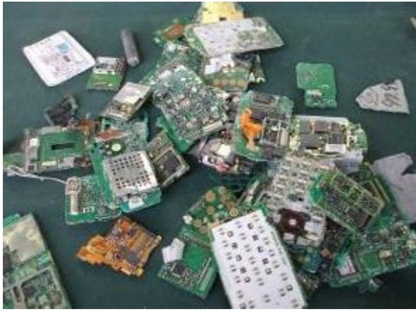
携帯電話のプリント基板：機械解砕後
