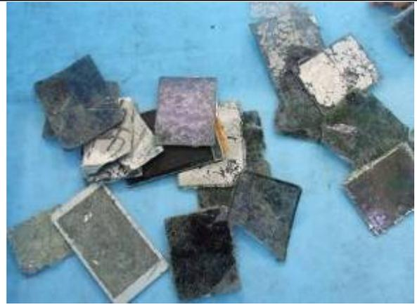
携帯電話の液晶：機械解砕後
