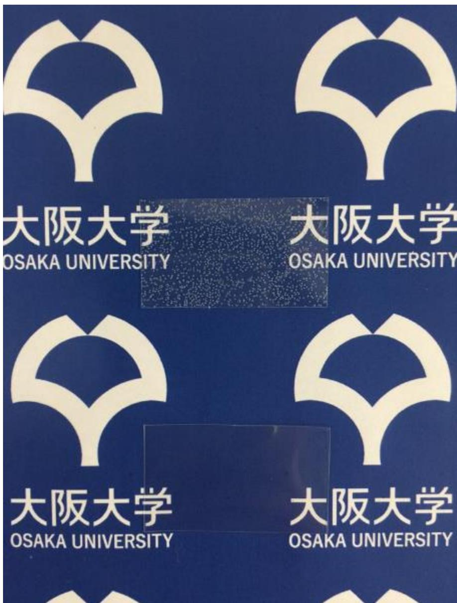
図 3-9 プレス後の PLA フィルム（上；現行条件、下；数日放置後）
