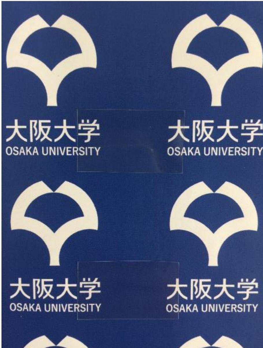
図 3-12 プレス後の PLA フィルム（上；現行条件の数日放置後、下；新規条件）
