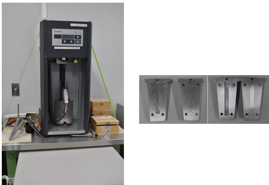
図 2-34 小型射出成形機と金型 2 種（ダンベル型、短冊状金型（右））
