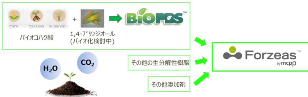
図 3-47 BioPBS と FORZEAS の製造フロー（三菱ケミカル）
