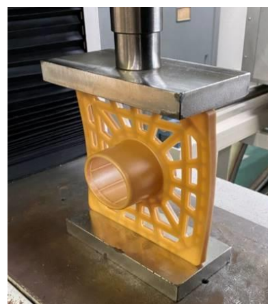
図 2-4-3-2 \alpha -olefin1 添加に伴う圧縮強度の変化（左）と試験の様子（右）
