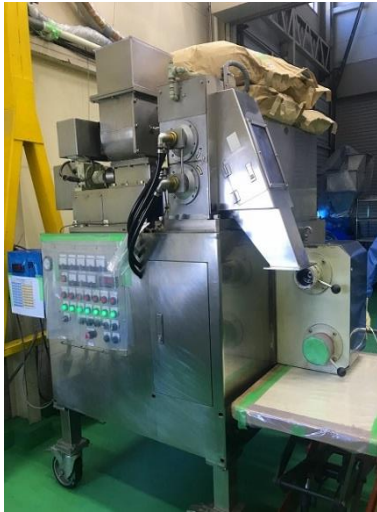
図 2-1-2-2 ローラーコンパクター（左）とその処理概要（右）
