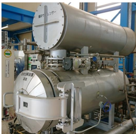
図 2-1-1-3 加水分解装置（左）とサンプル投入の様子（右）
