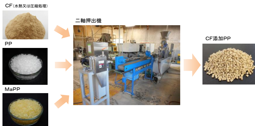
図 2-1-3-2 コンパウンド作製の概要とサンプル例
