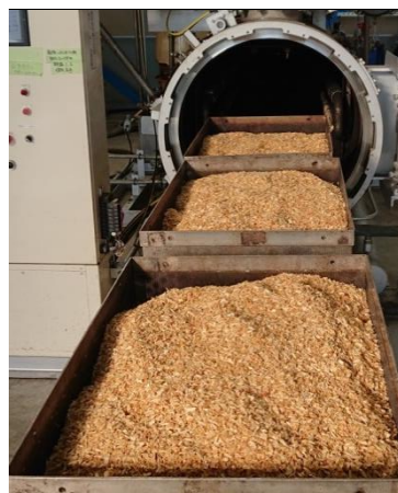
図 2-1-1-3 加水分解装置（左）とサンプル投入の様子（右）
