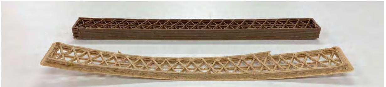
図 1-5. No.11. セルローズファイバー(CF) 400\mu\text{m} 40% 吸湿状態(下) No.11. CF 900\mu\text{m} 40%+乾燥処理(上)
