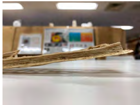
図 1-6. 吸湿状態のペレットで造形すると、発泡などにより収縮が非常に大きくでる
