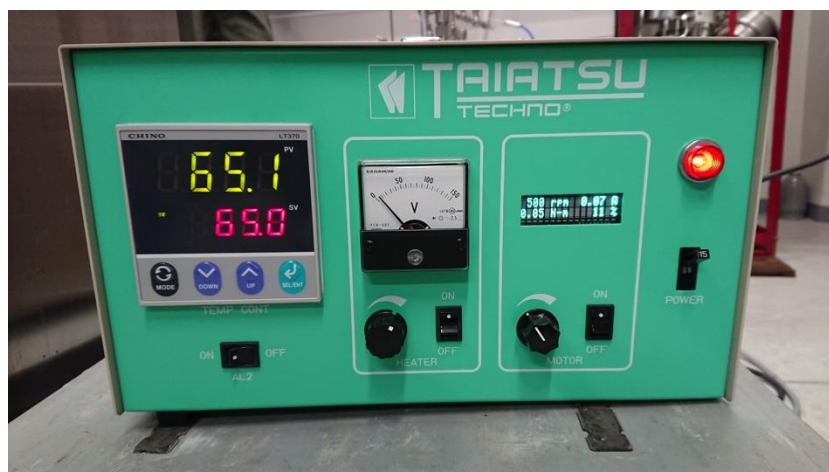
図3.34 重合に用いた耐圧金属容器のコントローラ（温度、回転数）
