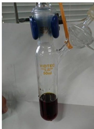
図3.36 アルゴンガス雰囲気下、シュレンク内で調製したNd触媒溶液
