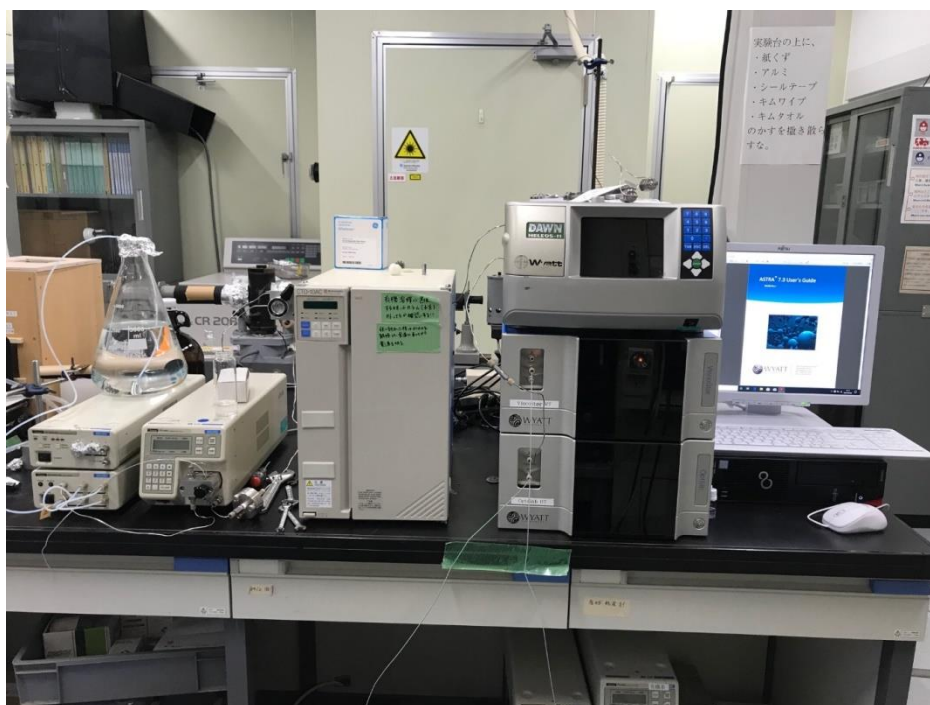
図 3.72 SEC に各種検出器を接続したシステムの写真
