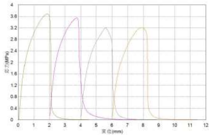
図 2.1.6.4 応力-ストローク線図 (リサイクル 2 回目)
