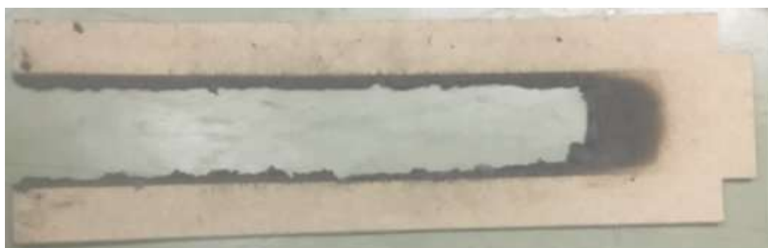
図 1.1.6.2 燃焼性試験サンプル例 (試験後)
