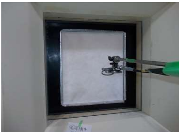
図 1. 1. 8. 7. 2 PET 不織布遮音性試験状況
