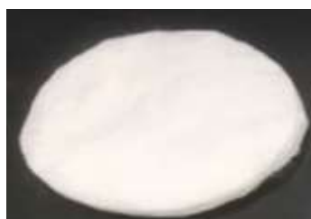
図 3.2.1.2 不織布（ポリエステル繊維）による自動車吸音材
