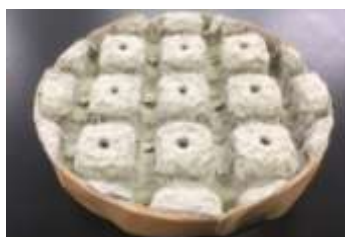
図 3.2.1.1 パルプ繊維による自動車吸音材
