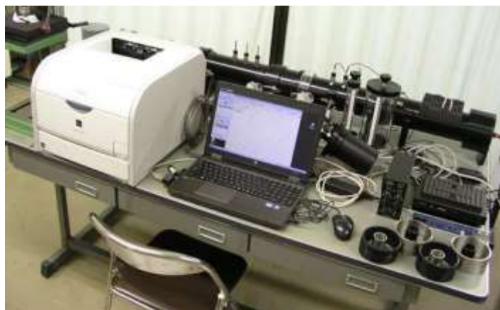
図 1. 1. 8. 1. 1 垂直入射吸音率測定装置 (WinZacMTX)
