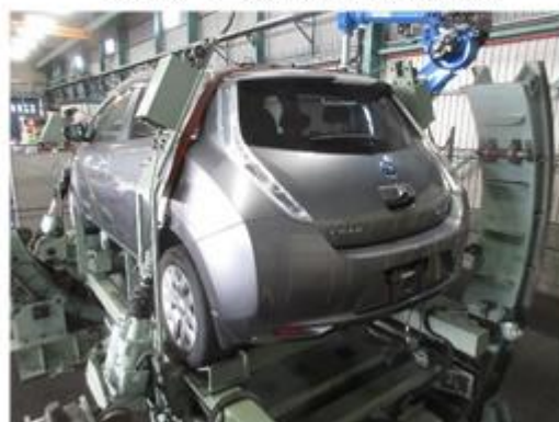
後側 固縛装置作動状態
