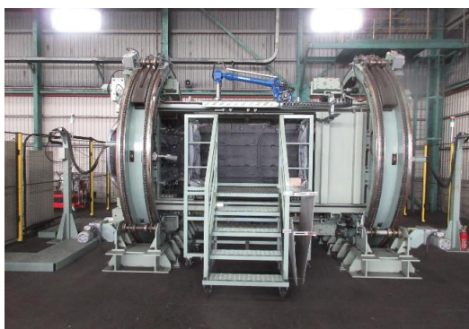
90° 傾転時に作業台を設置した状態
