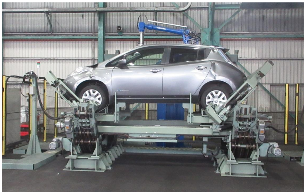
図 3. 1. 1-26 LEAF を車両傾転装置に装入した状態
