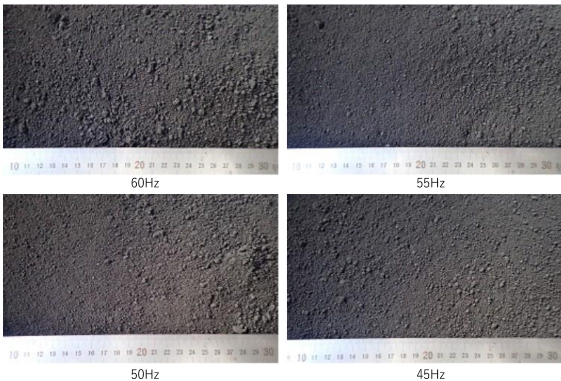
図 3.3.2-23 LIB Co 系角型 各周波数にて回収された集塵物
