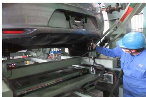
後部 脱落防止ワイヤー取付
