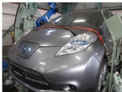
前側 固縛装置作動状態
