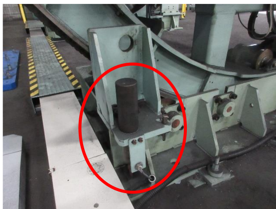
90° ロックピンをロックピンホルダーに収めた状態
