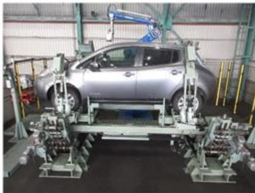
①車体の固縛が完了した状態
