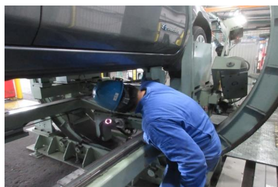
右前側 脱落防止ワイヤー取付
