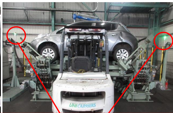
車両位置確認パトランプの左右とも緑ランプ点灯
