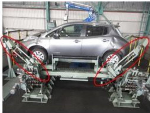
固縛装置未作動状態
