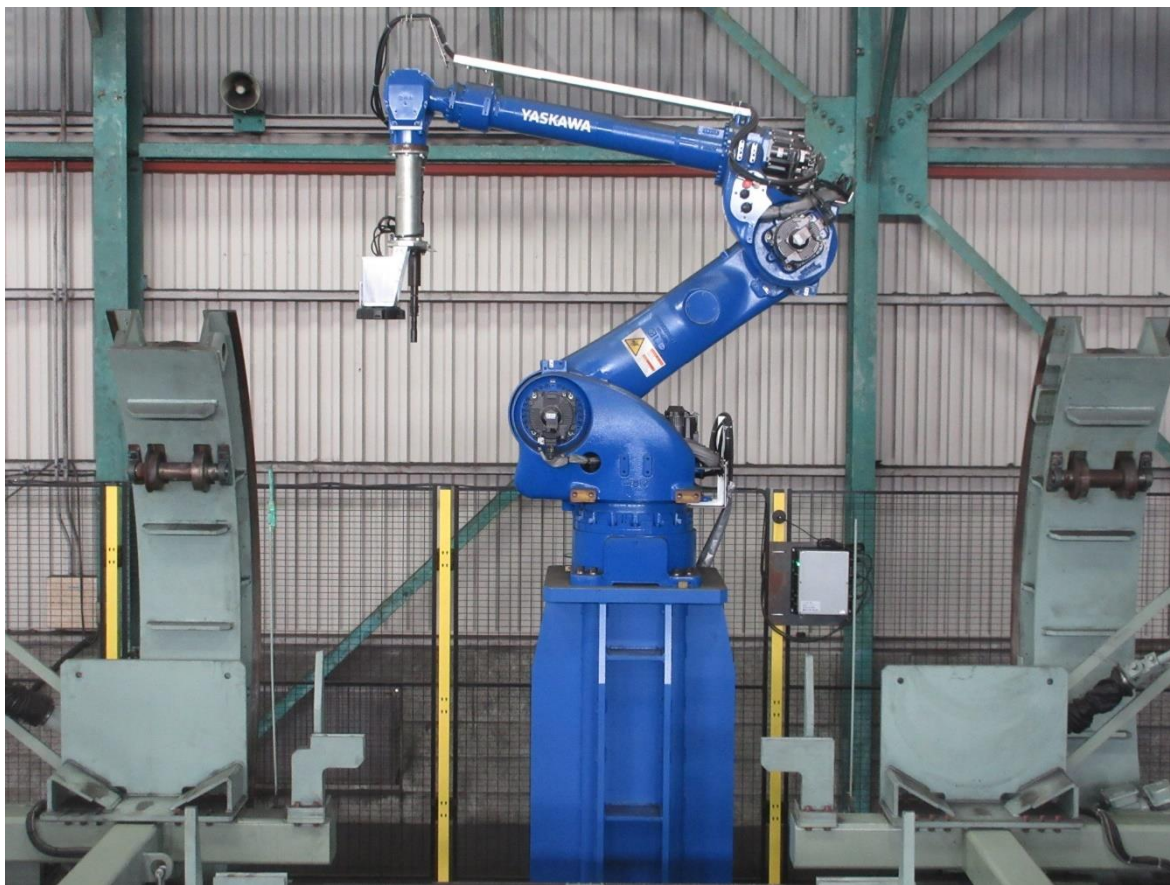
図 3.1.1-11 株式会社安川電機製ロボット MOTOMAN GP180-120
