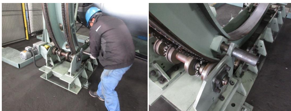
180° ロックピンホルダーに90° ロックピンを挿入した状態
