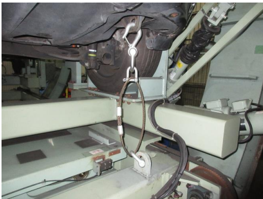
LEAF後側 脱落防止ワイヤー取り付け状態
