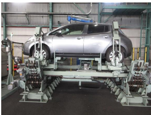
③LIBユニットを押さえ込んだ状態で 0° 位置に戻った状態
