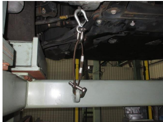
LEAF左前側 脱落防止ワイヤー取り付け状態
