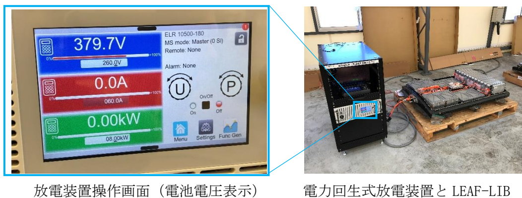
図 3.2.2-7 放電装置と LIB との接続の外観
