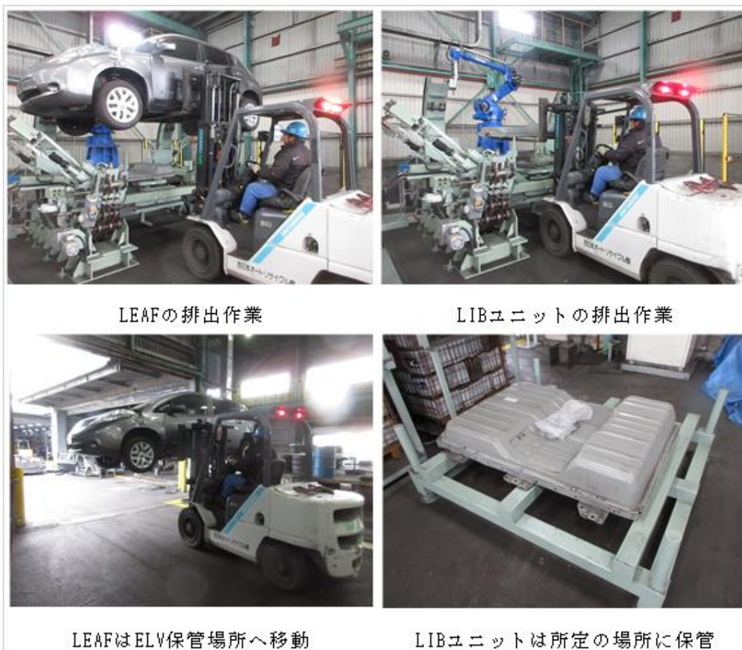
図 3. 1. 1-31 LEAF 及び LIB ユニットの排出作業
