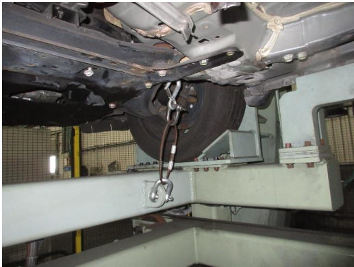
LEAF右前側 脱落防止ワイヤー取り付け状態
