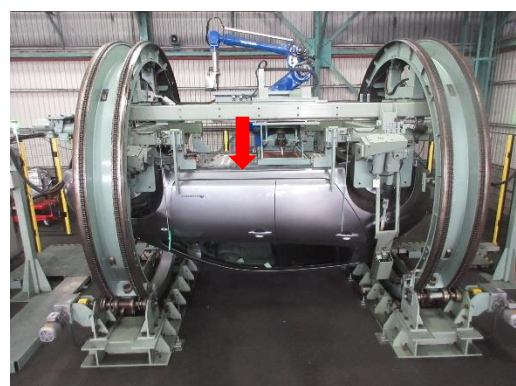
②シフトリフト装置がLIBユニットを押さえ込んでいる状態
