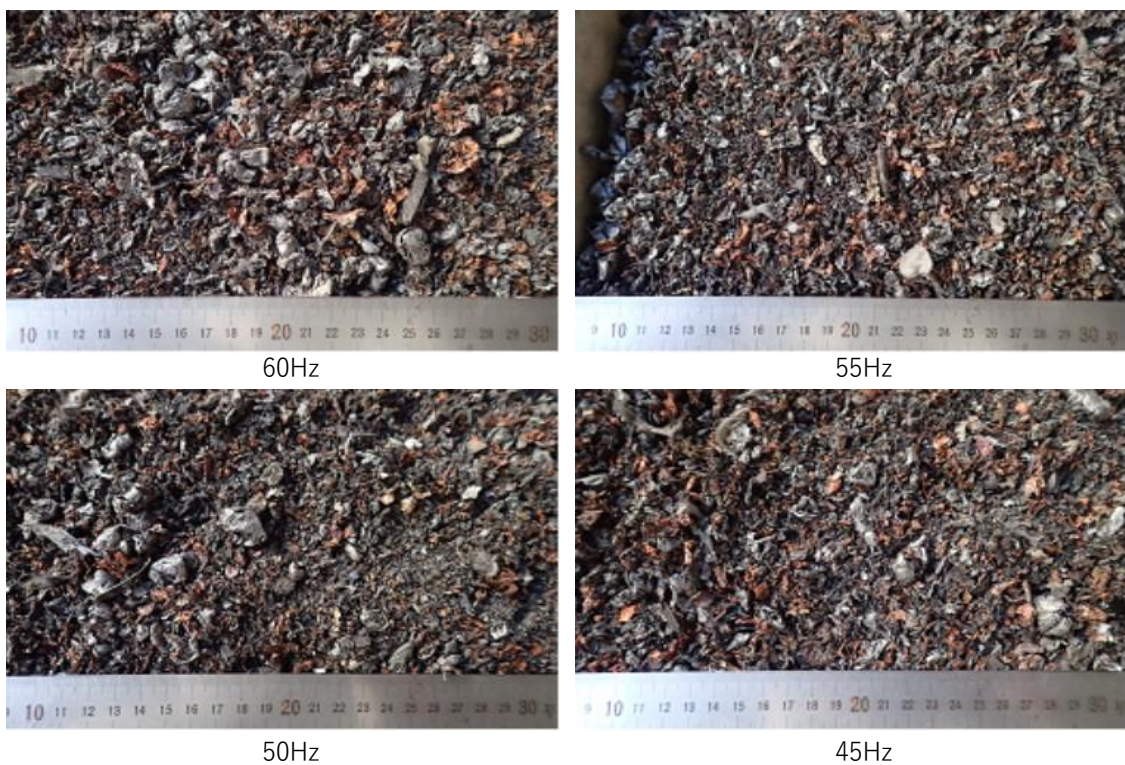
図 3.3.2-22 LIB Co 系角型 各周波数にて回収された非磁着物
