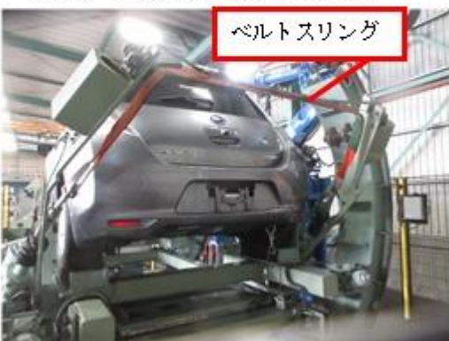
後側 固縛装置未作動状態
