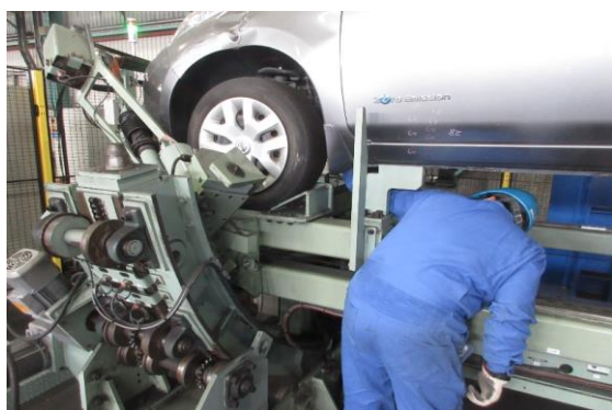
左前側 脱落防止ワイヤー取付
