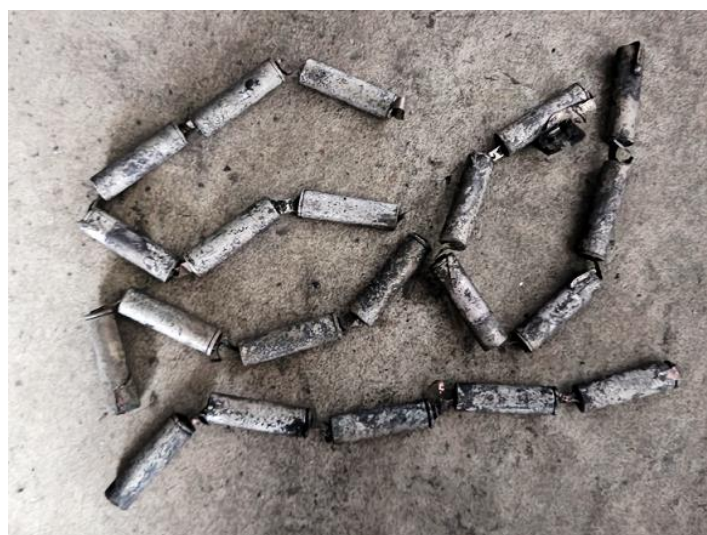
図 3.3.2-9 LIB Ni 系円筒型 熱分解物
