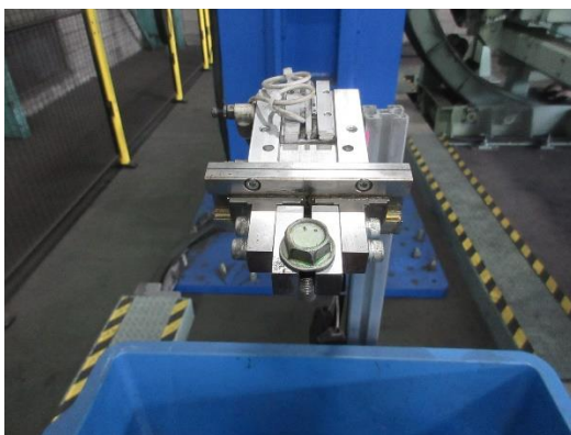
リニアスライドハンドがねじを固定している状態
