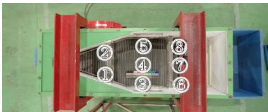
写真 4.1.4 エアテーブル選別における風速測定箇所
