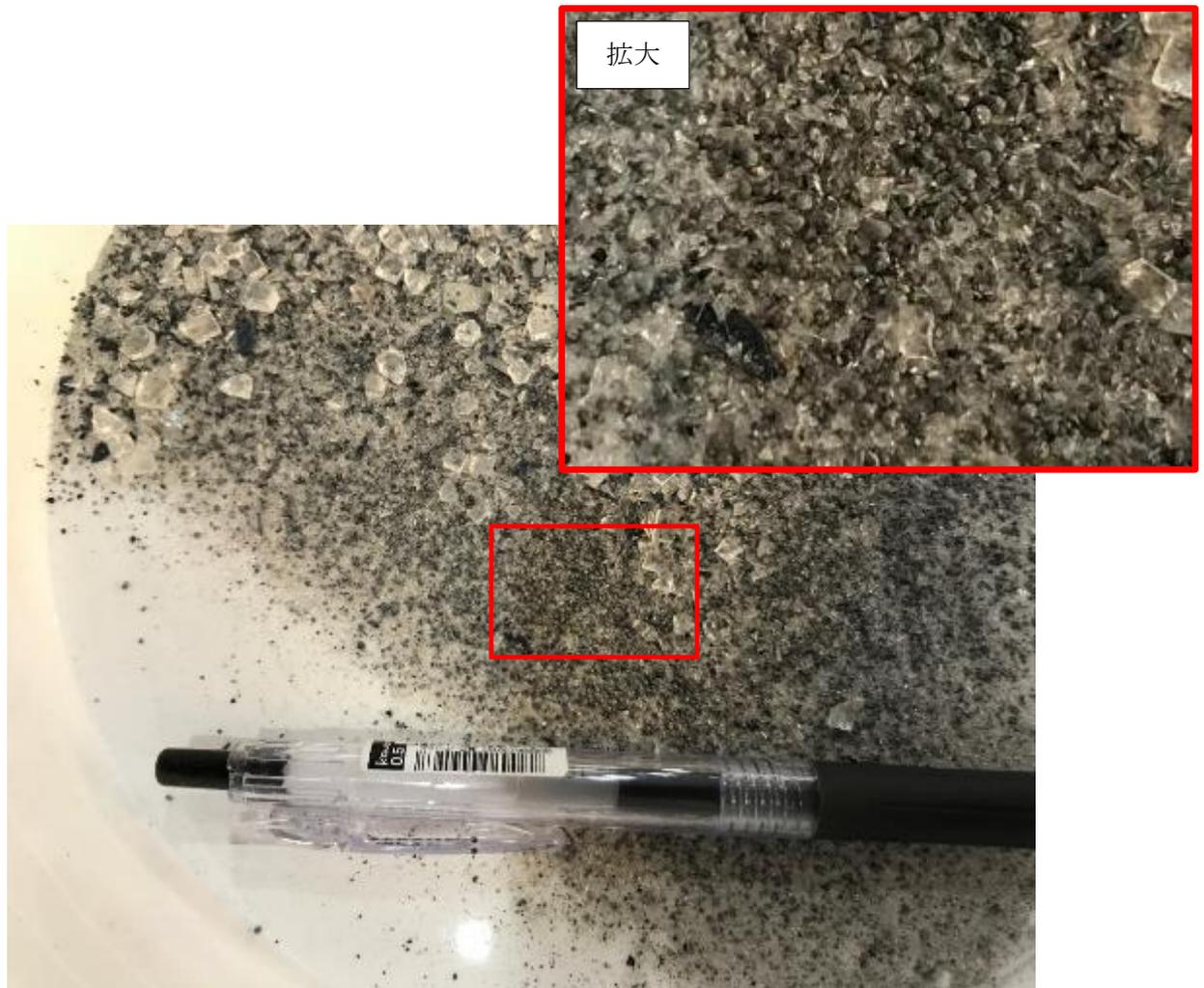
写真 4.2.6 エアテーブル下に回収されたはんだボール他
