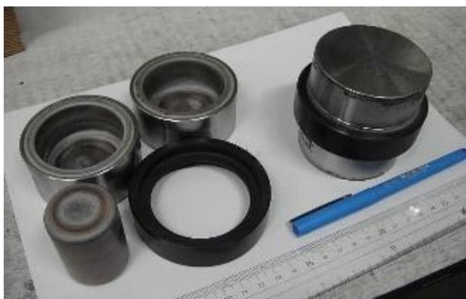
写真 4.1.9 振動ミルの粉碎用シリコンセル
