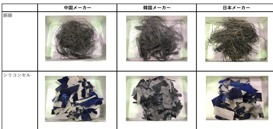
写真 4.5.1 銅線及びシリコンセルの外観
