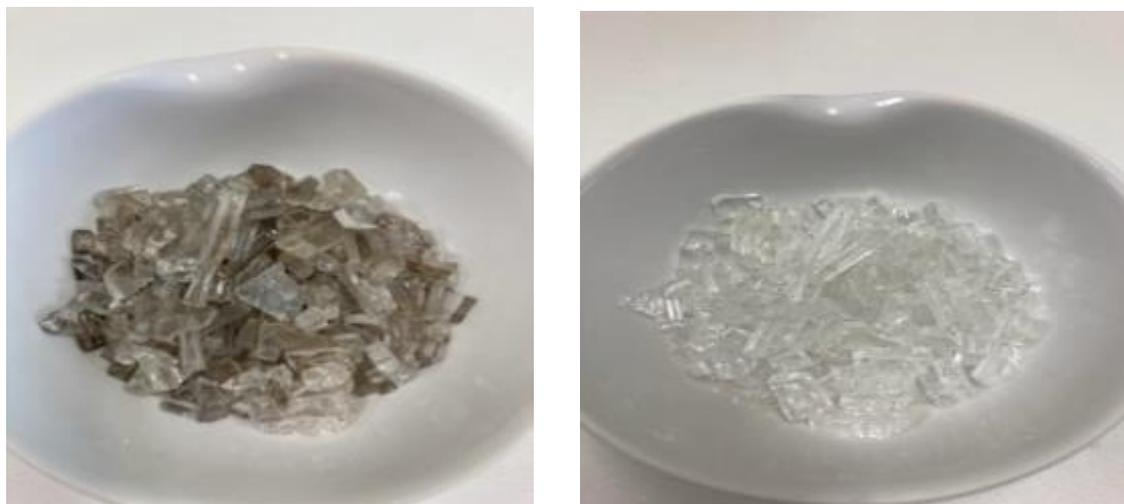
写真 4.4.4 イグロス測定前後の外観 (左：測定前、右：測定後)
