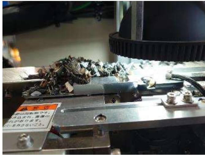
図 31 コンベア上の部品詰まり
