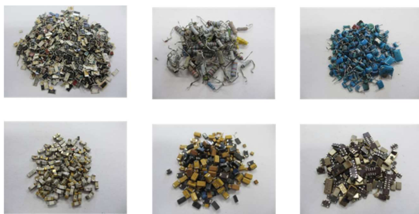
図 4 蒸気分離後の電子部品
