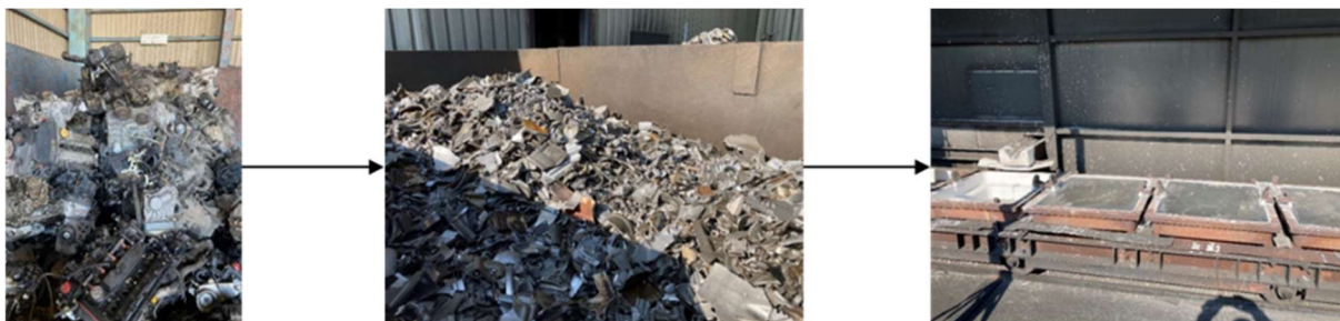
図 41 埼玉のエンジンリサイクル工場における破碎後溶解プロセス
