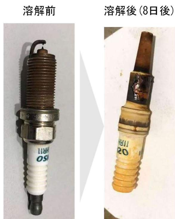
図 58 着火プラグの溶解前後比較
