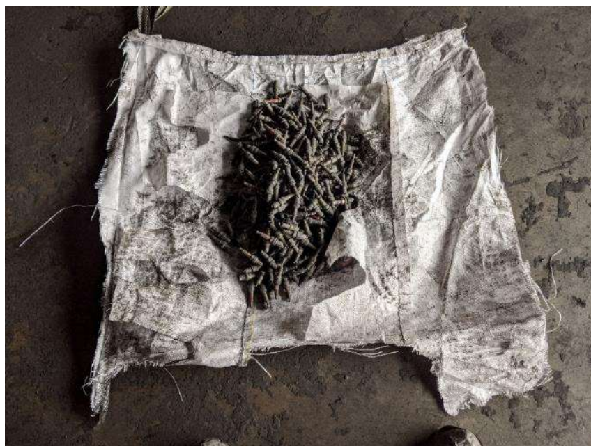
図 40 1 週間分の残渣からピックアップした着火プラグ（332 本）
