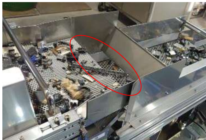
図 30 篩装置の長物部品のブリッジ
