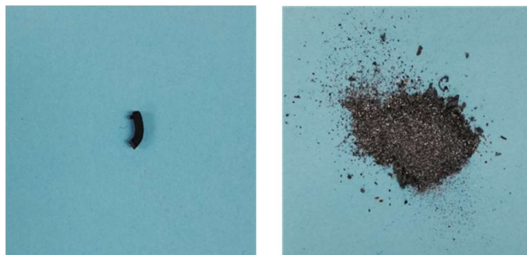
図 33 分離後の外側電極（左）と中心電極（右）
