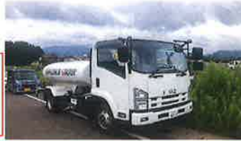
散水車による粉じん対策
