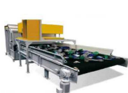
廃プラの選別設備
