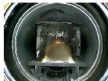
(鋼製ケースに入れての処理)
