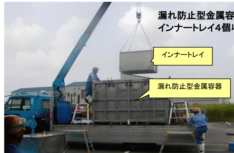
漏れ防止型金属容器へのインナートレイの積み込み
