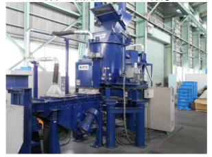
写真1 機械前処理 CFS 磁選機 排出口
