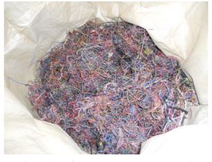
写真 21 振動篩機下から回収したハーネス(10mm↓)
