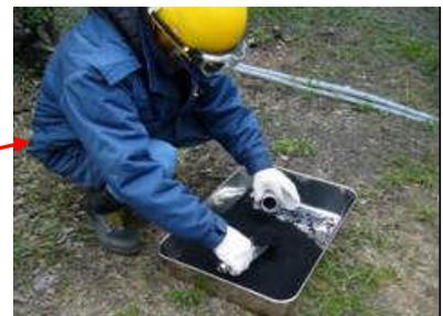
デモ機付帯のバグフィルター下部からの飛灰のサンプリング
