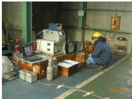
煙道からの排ガスのサンプリング(左) 排ガス分析(右)
