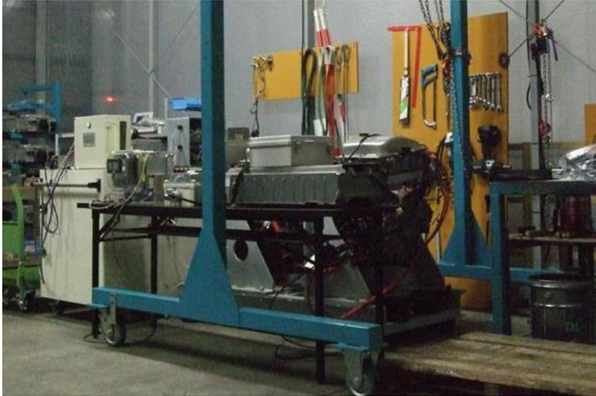
HVシステムとしてモーターとして試験する
