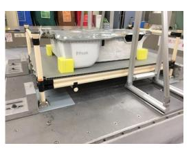
写真 3-4 落下防止用冶具固定
