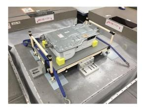
写真 3-1 ランダム振動試験(ベルトあり)
