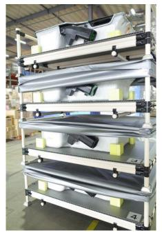
写真 3-14 【A】イレクターパイプ 4 段積
