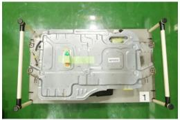
図 3-5 イレクターパイプ式循環ラック+ダミー電池パック
