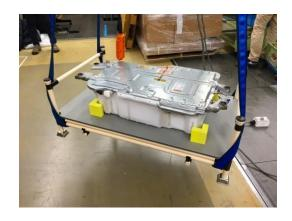
写真 3-93面方向の落下試験
