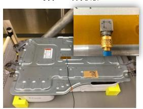
写真 3-7 加速度ピックアップ取り付け
