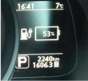
図 4-19 EV のメーターによる残容量確認
