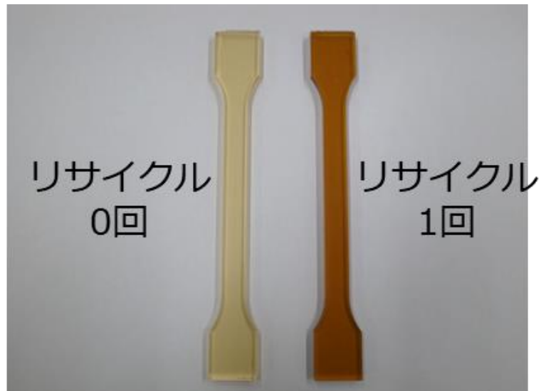
図 3-4 中型機を用いたリサイクル時の成形体
