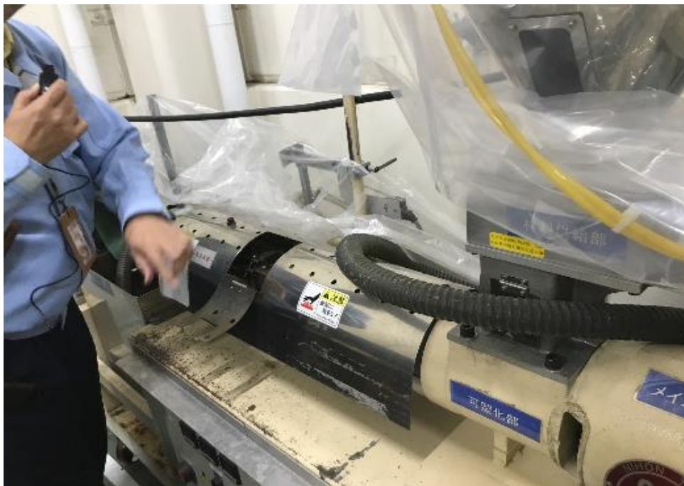
図 5-7 粉碎されたプラスチックを再度ペレット化する装置
