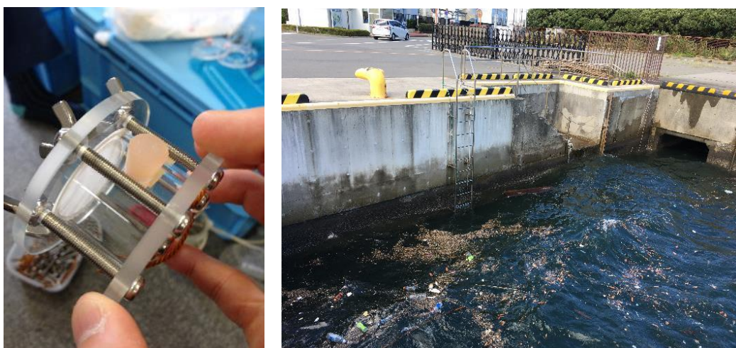
図 4-4 岸壁に設置するためのサンプルホルダー (左) と設置予定の JAMSTEC 岸壁
