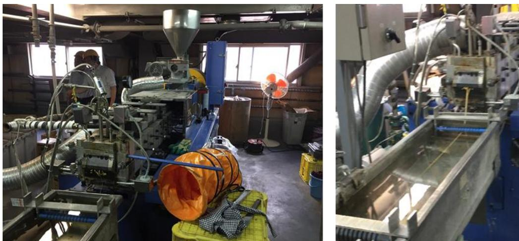
図 5-1 大型二軸押出混練機(左)全体、(右)吐出口
