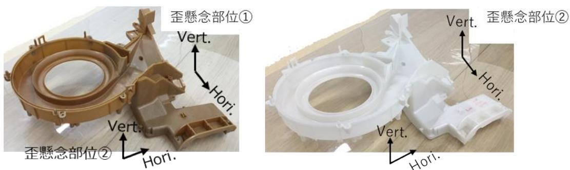
図 6-26 PE-CNF10 の寸法測定サンプル
