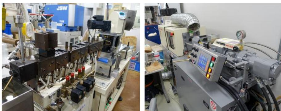
図 4-1 (左) 二軸押出機および(右)射出成形機
