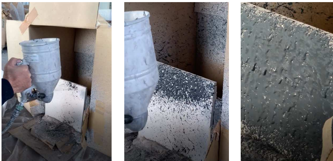
図 4-4 発泡ジオポリマー硬化体の現場吹付試験
