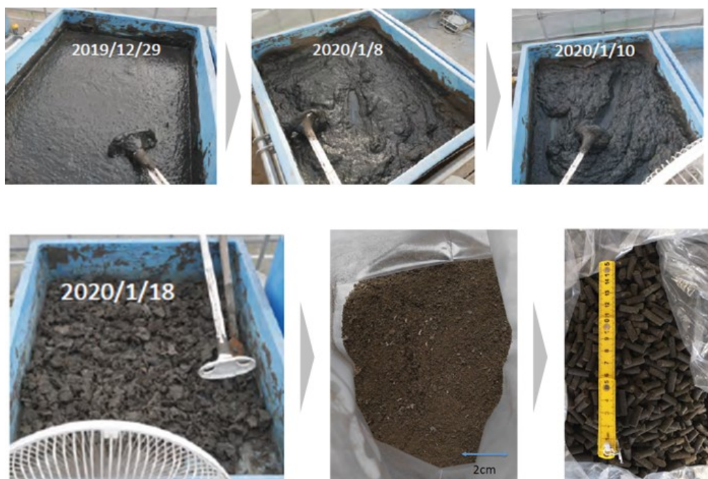
上が乾燥中、下左が乾固物、下中が粉碎した乾固物、下右が成形されたペレット
