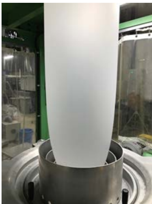
図 61 インフレーション成形工程
