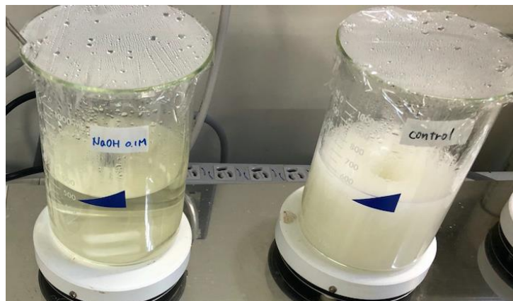
図 3-4 アルカリ添加による 100°Cでの溶解度の上昇 1
