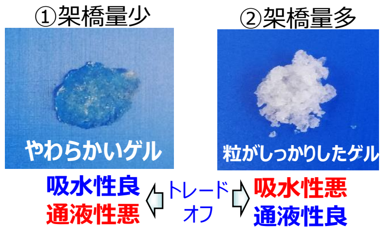
写真2 吸水試験後の吸水性樹脂の状態
