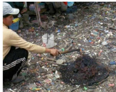
インドネシアでの被覆電線の野焼き (2008年 アジア経済研究所 小島道一氏撮影)
