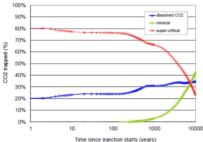
第 3. 1-4 図 萌別層砂岩層に CO<sub>2</sub> を圧入した際の鉱物固定化量の推定
