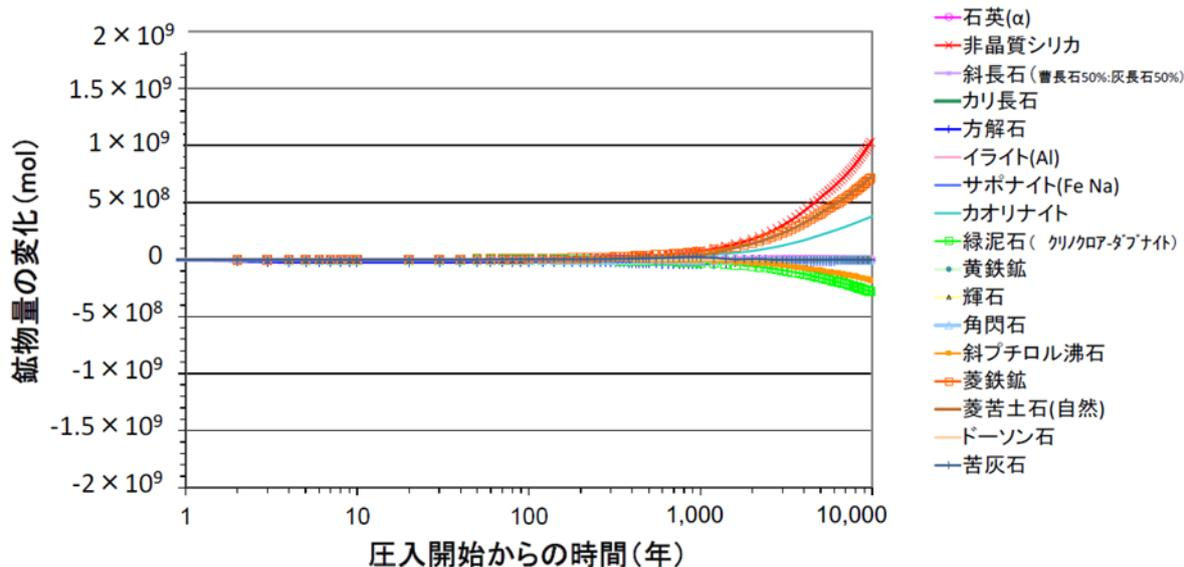
第 3. 1-3 図 萌別層砂岩層に CO<sub>2</sub> を圧入した際の鉱物量変化量の推定
