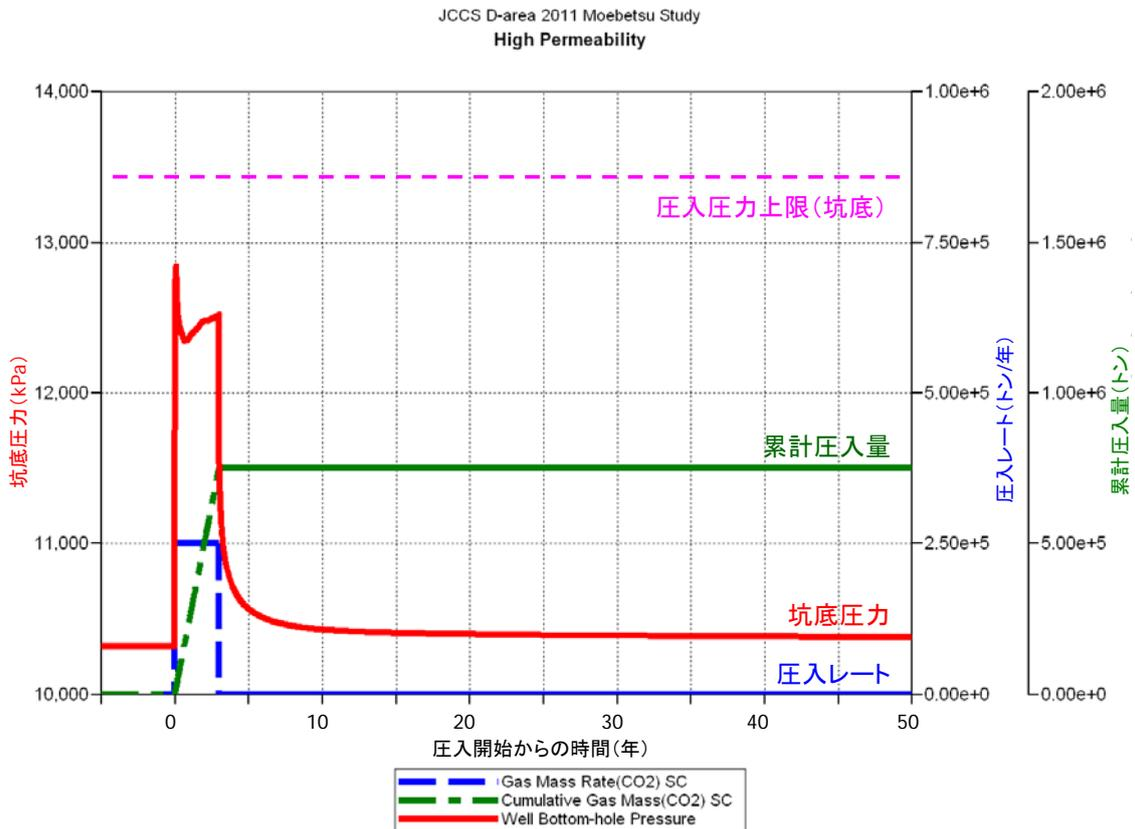
注：萌別層圧入井の掘削により確認した萌別層の浸透率は、本シミュレーションの設定値よりも高いことが確認された。よって、CO<sub>2</sub>圧入時の圧力上昇は、本シミュレーション結果よりも低くなることが予想される。
