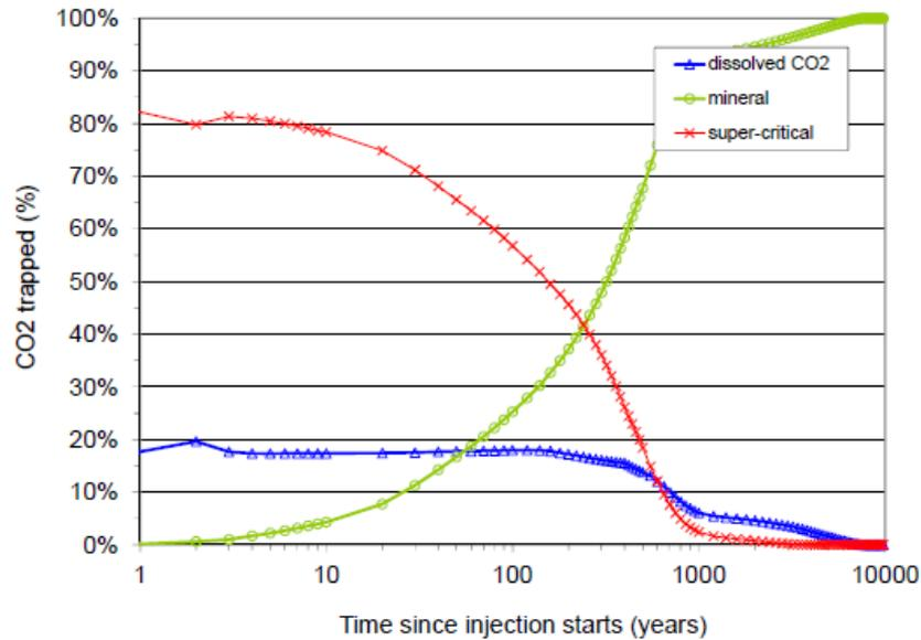
第 3.1-2 図 滝ノ上層 T1 部層に CO<sub>2</sub>を圧入した際の鉱物固定化量の推定
