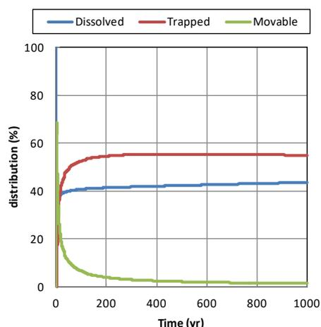
第 2.2-64 図 ベースケースにおける CO<sub>2</sub>の貯留フォーム (割合) の変化 (平成 23 年度シミュレーション結果)
