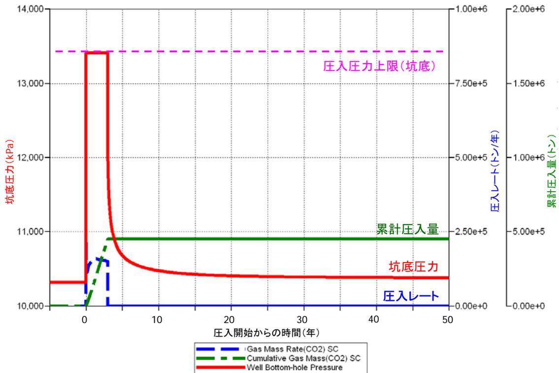
注：萌別層圧入井の掘削により確認した萌別層の浸透率は、本シミュレーションの設定値よりも高いことが確認された。よって、CO<sub>2</sub>圧入時の圧力上昇は、本シミュレーション結果よりも低くなるが予想される。
