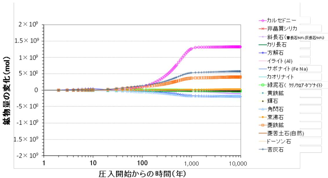
第 3.1-1 図 滝ノ上層 T1 部層に CO<sub>2</sub> を圧入した際の鉱物変化量の推定
