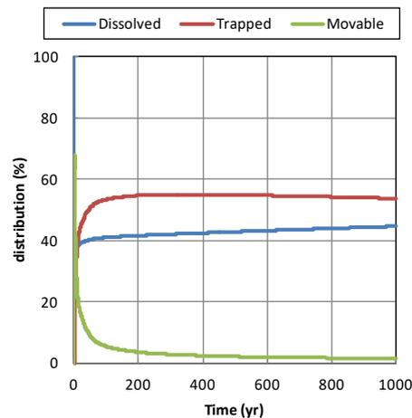
第 2.2-66 図 高浸透率ケースにおける CO<sub>2</sub>の貯留フォーム（割合）の変化（平成 23 年度シミュレーション結果）
