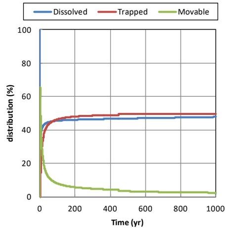
第 2.2-65 図 低浸透率ケースにおける CO<sub>2</sub>の貯留フォーム（割合）の変化（平成 23 年度シミュレーション結果）
