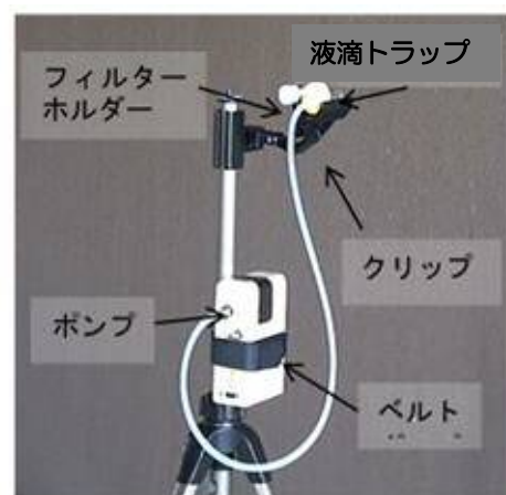
図 41 直径 13 mmオープンフェース型円形フィルターを使用した場合のサンプリング用捕集器具 一例
