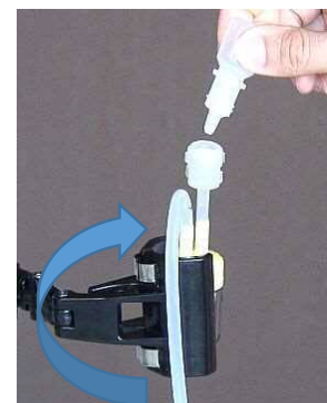
図 42 直径 13 mm フィルターを使用した場合の蛍光染色方法
